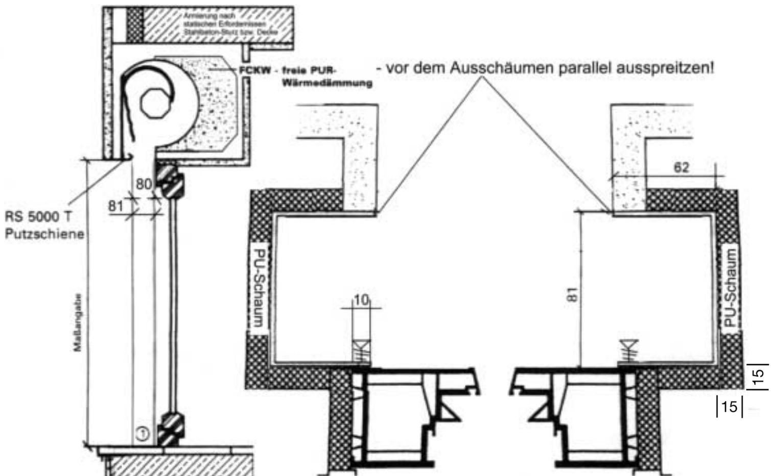
① Die Unterputzschiene ist bauseits gegen Wassereintritt in das Mauerwerk abzudichten.
